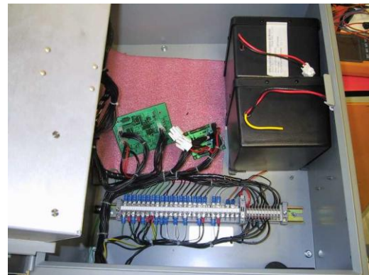
Figure 12 : Le relais SEL-351R dans son coffret.
